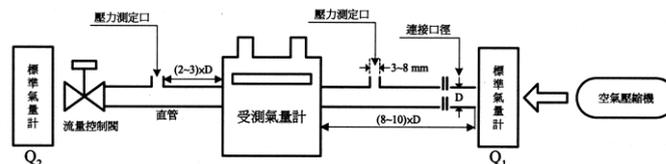
圖 B.2 氣量計測試配置參考圖例
